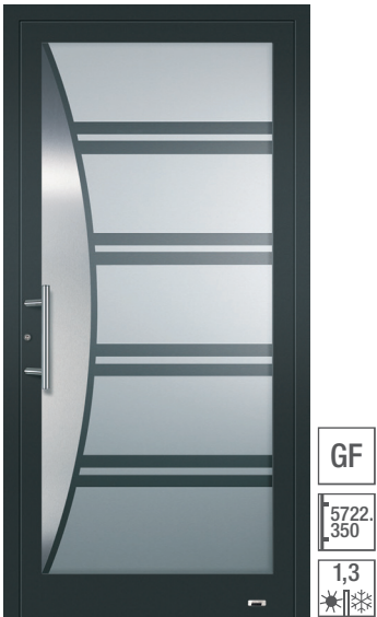
5456 Verglasung: Wärmeschutzisoliervlas, vorne: VSG beschichtet, Mitte: ESG mattiert mit klaren Streifen und NIRO-Design-Applikation, hinten: ESG, Oberfläche: FS Nightgrey ca. RAL 7016.
