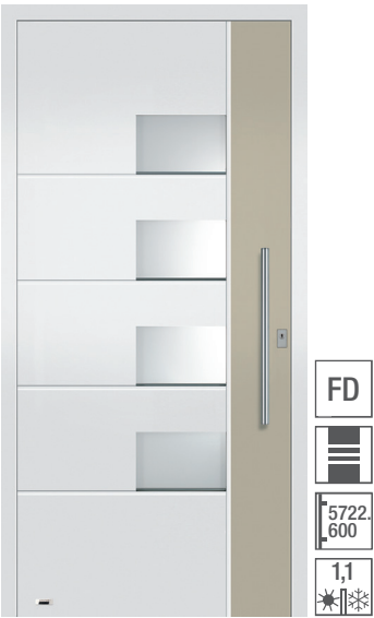
5001 Stoßgriff auf Füllung montiert, vorne: VSG mattiert mit klaren Streifen, hinten: Float beschichtet, Oberfläche: Grundfarbe Feinstruktur ca. RAL 9016, Applikation Metallic-Feinstruktur Beige.
