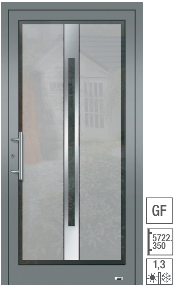
5459 Wärmeschutzisoliervlas, vorne: VSG beschich- tet, Mitte: ESG mattiert mit klarem Rand und Streifen in der NIRO-Design-Appli., hinten: ESG. Oberfl: RAL 9007 Graualuminium matt
