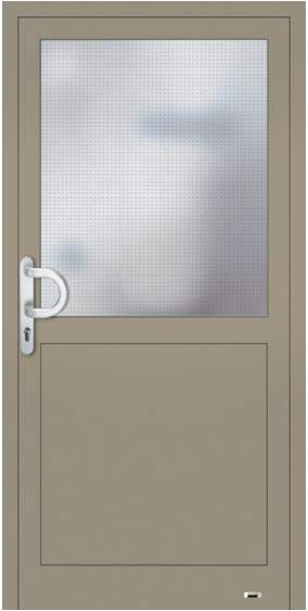
5506-2 ADVANCE 75 mit nach unten versetzter Quersprosse, Verglasung: Wärmeschutzisoliertglas vorne VSG beschichtet, hinten: Mastercarre, alternativ: Float oder Chinchilla weiß, unten wärmegeädmmtes;Alu-Sandwich-Paneel, 30 mm stark, Oberfläche: Metallic-Feinstruktur Beige
