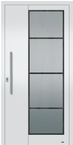
5508 geteilte Sprossen 90 mm, 330 mm breiter Applikation außen aufgebracht, Wärmeschutzisoliertglas, vorne: VSG mattiert mit klarem Rand und Streifen; hinten: Float beschichtet; Oberfläche: RAL 9016 weiß
