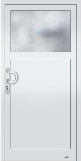
5506-1 ADVANCE 75 mit 100 mm Quersprosse, Verglasung: Wärmeschutzisoliertglas vorne VSG beschichtet, hinten: Mastercarre, alternativ: Float oder Chinchilla weiß, unten wärmegeädmmtes;Alu-Sandwich-Paneel, 30 mm stark. Oberfläche: RAL 9016 Verkehrs-weiß
