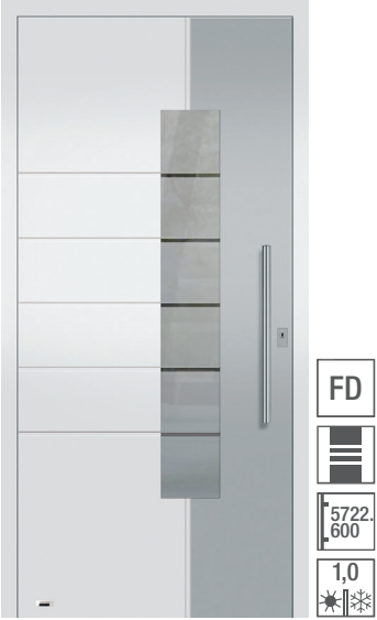
5007 Stoßgriff auf Füllung montiert, vorne: VSG mattiert mit klaren Streifen, hinten: Float beschichtet, Oberfläche: Grundfarbe Feinstruktur ca. RAL 9016, Applikation RAL 9006 Weißaluminium matt.
